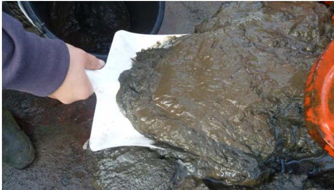
Abbildung 4: Entnahme von schluffigem Material aus der Greiferprobe
